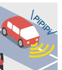
車載のカメラにより道路上の車線を検知し、車線からはみ出しそうになった場合やはみ出した場合には、**ドライバーに対して警報**します。
