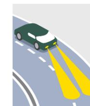
ヘッドライトのハイビームとロービームの自動切替、照射範囲の自動制御などにより、**ドライバーの前方確認をサポート**します。
