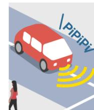
車載のカメラにより道路上の車線を検知し、車線からはみ出しそうになった場合やはみ出した場合には、**ドライバーに対して警報**します。
