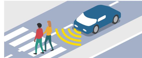
車載のレーダーやカメラにより前方の車両や歩行者を検知し、衝突の可能性がある場合にはドライバーに対して警報します。さらに衝突の可能性が高い場合には、**自動でブレーキを作動**します。
