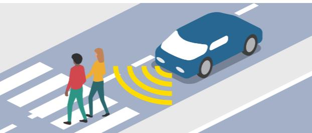
車載のレーダーやカメラにより前方の車両や歩行者を検知し、衝突の可能性がある場合にはドライバーに対して警報します。さらに衝突の可能性が高い場合には、**自動でブレーキを作動**します。
